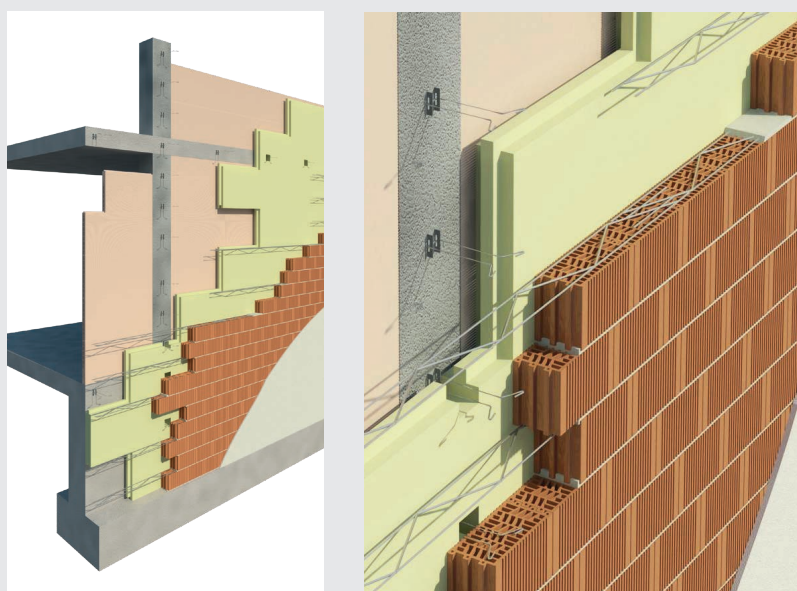
Imagen 4: Fachada autoportante de bloque Termoarcilla. Hoja exterior de bloque Termoarcilla tangente a la estructura arrancando desde cimentación, cabeza de muro de sótano o forjado de primera planta, disponiendo de armadura de tendel y anclajes de retención a la estructura. Aislamiento térmico continuo por delante de la estructura. Solución sin puentes térmicos
