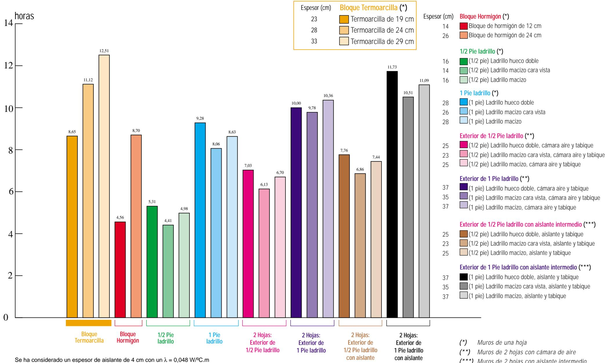
Se ha considerado un espesor de aislante de 4 cm con un  $\lambda = 0,048 \text{ W/}^\circ\text{C.m}$
